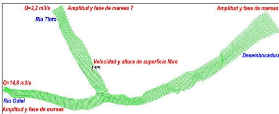
**Figura 3:** Malla computacional y condiciones de contorno hidrodinámicas.
