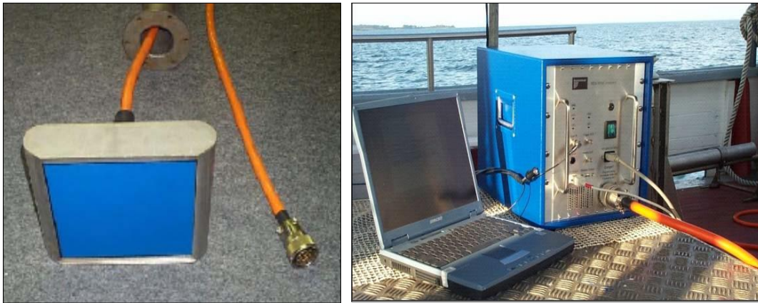
Figura 5. Sondador paramétrico INNOMAR SES-2000 COMPACT; transducer y centralita electrónica del sondador.
